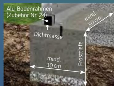
Eine weitere Möglichkeit, Gartenhäuser auf unebenem Boden aufzustellen, ist ein Punktfundament in Verbindung mit einem **Alu-Bodenrahmen**.
